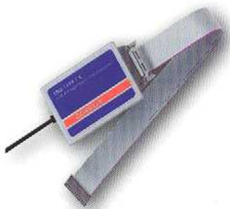
図5. USB-1149.1/Eコントローラ
